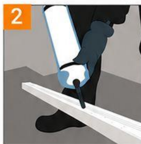
نصب رانر کف
