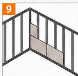
اجرای حصیری پنلها
