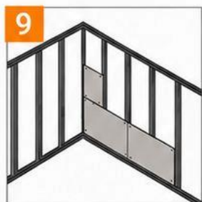
اجرای حصیری پنلها
